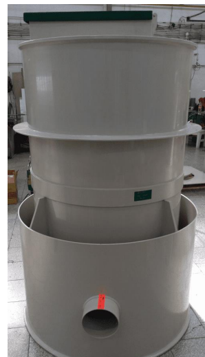
Obr. Kanalizační měrná šachta
